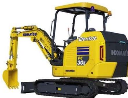
写真-2 プロジェクト A-① バッテリー駆動式ミニショベル PC30E-5 (一例)
